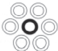
Схема карбонатного элемента. Согласно идее авторов, круглый катод в нем будет окружен кольцом из круглых же анодов
